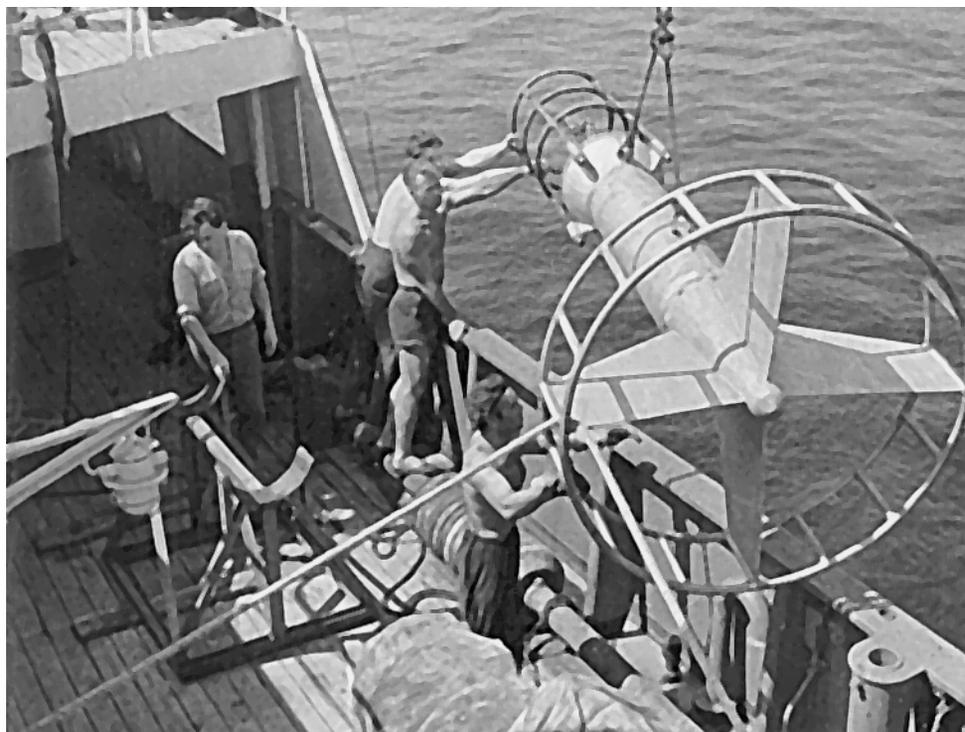
*Постановка глубоководного автономного турбулиметра (ГАТ-3)*
