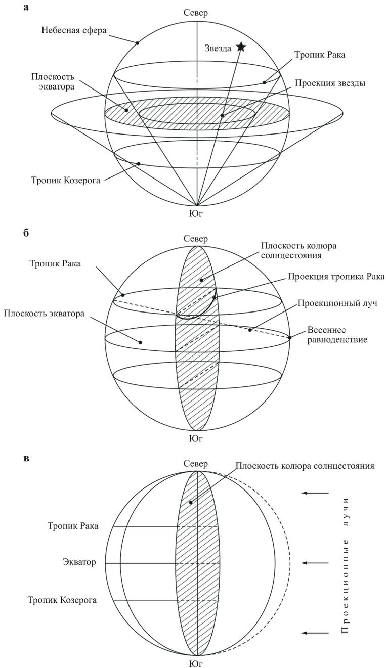
*Рис. 2. Методы проецирования, применяемые в астрологиях: а) планисферное (стереографическое) проецирование из южного полюса; проецирование ведется на плоскость экватора; б) стереографическое проецирование из точки весеннего равноденствия; проецирование ведется на колура солнцестояний; в) ортографическое проецирование из точки, удаленной в бесконечность; проецирование на колура солнцестояний; точка весны, как и в случае «б», находится в центре астроблиши*
