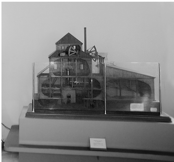
Рис. 4. Действующая модель пароатмосферной машины И. И. Ползунова (проект 1766 г.), мастерская учебно-наглядных пособий кафедры паросиловых установок Одесского института инженеров морского флота. Политехнический музей
