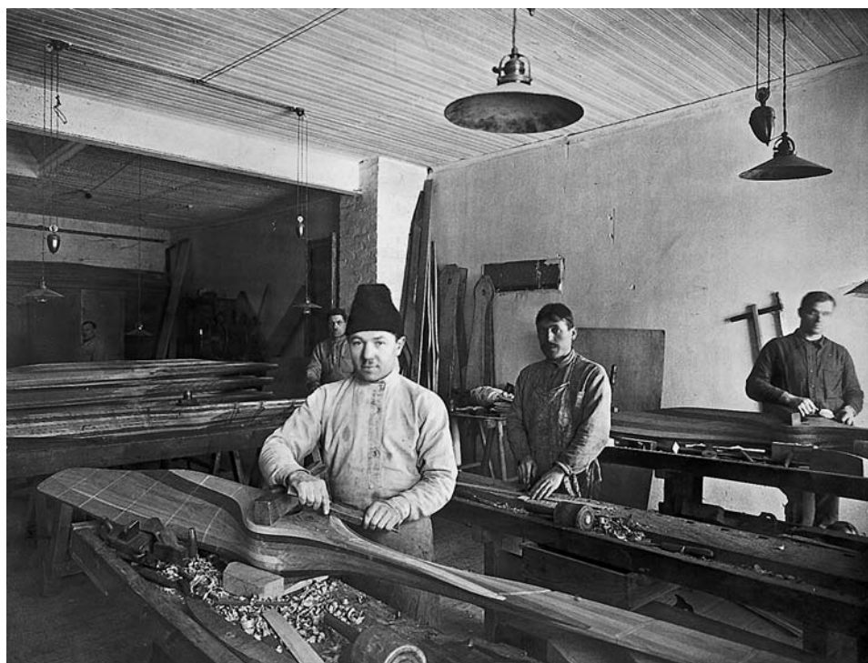
Рис. 3. Производство пропеллеров на ПРТВ
