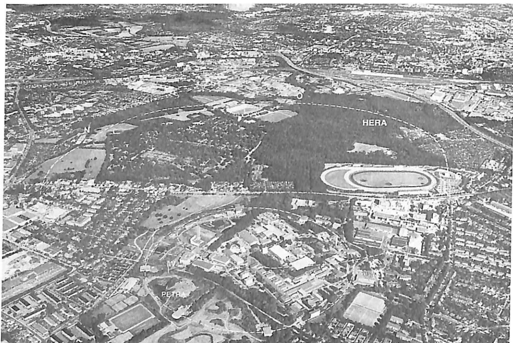
Общий вид лаборатории ДЕЗИ в Гамбурге. Пунктиром помечены орбиты ускорителей – накопителей ПЕТРА и ГЕРА
