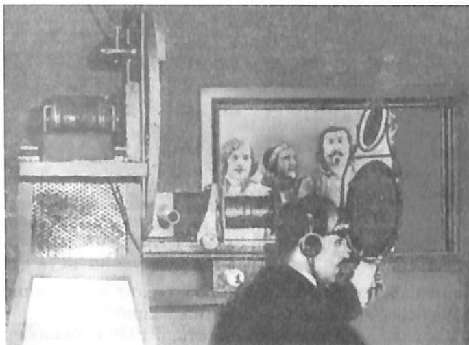
*Рис. 4. Телепередача оперетты Ф. Легара «Веселая вдова». Вид из аппаратной, 1936 г. Передающая телекамера (слева) создавала при работе шум, поэтому аппаратная, во избежание наводок на микрофоны, была отделена от студии смотровым стеклом. Телекамера закреплялась неподвижно; оператор рукой регулировал поворот зеркала, через которое происходило в студии передавалось в объектив камеры*
