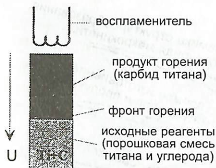
Принципиальная схема СВС-процесса
