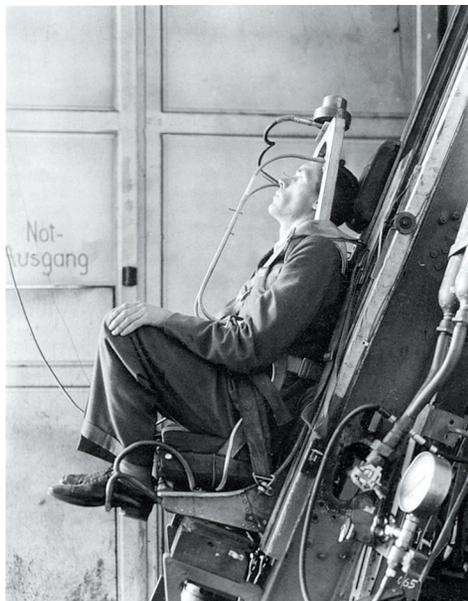
*Катапультируемое кресло фирмы «Хейнкель» на испытательном стенде*
