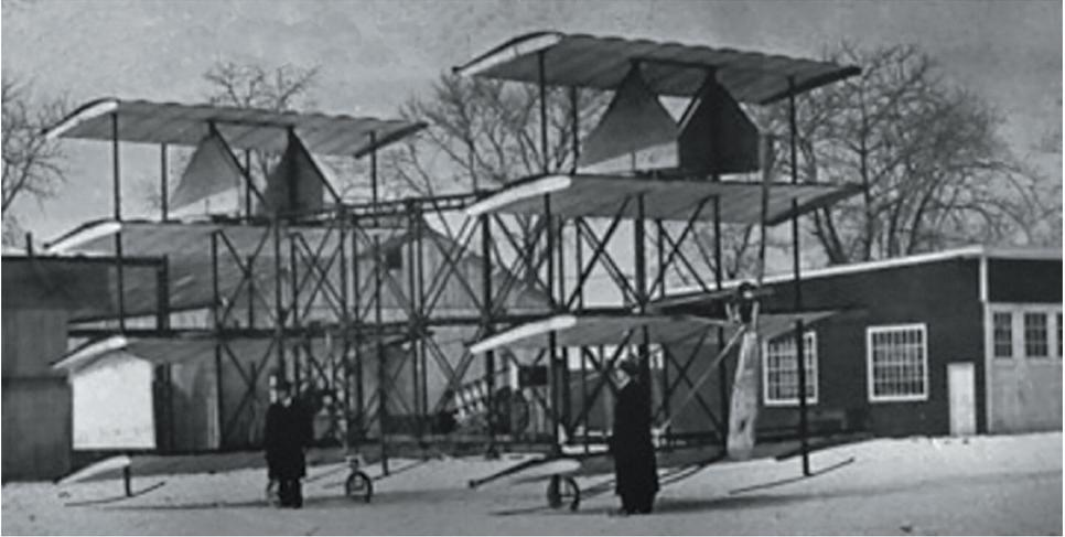
*Рис. 20. Квадроплан-тандем, который построили Лунд и Дуайт*
