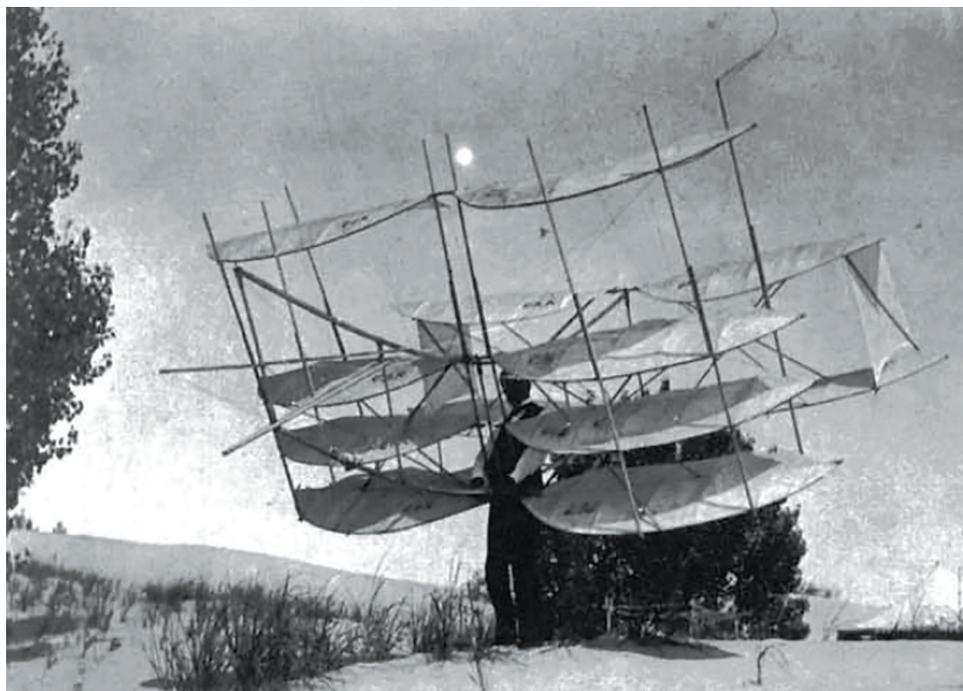
Рис. 4. Планер-пятиплан О. Шанюта. Второе сверху крыло снято – планер испытывался в полете в различных конфигурациях
